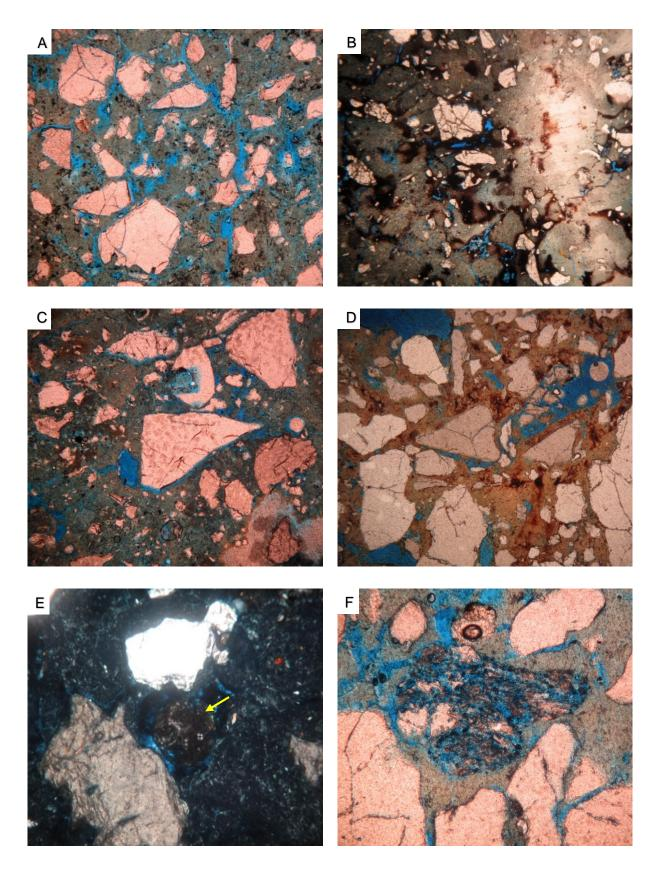
Figura 11 – Aspectos gerais da petrografia. A) Ausência de imbricamento dos grãos e elevada porosidade. B) Presença forte oxidação. C) Grão de quartzo com arrestas de alto ângulo. D) Grão de quartzo com aresta de alto ângulo. E) Fragmento de rocha(?) com inclusão de minerais. F) Elevada dissolução telodiagenética em grão de quartzo. Fonte: Autoria Própria.
