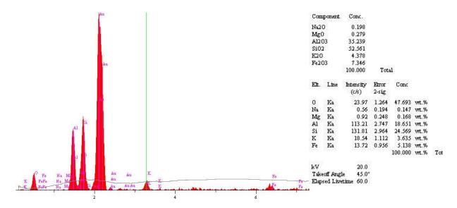
Figura 22 - Espectro EDS mostrando assinatura química da caulinita, ponto 6 - Fig. 13C. Fonte: Autoria própria.
