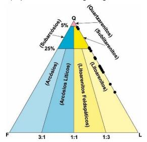
Figura 13 - Diagrama ternário de classificação das amostras dos arenitos da região de Mucuri – Costa Dourada (Modificado de Folk, 1980)
