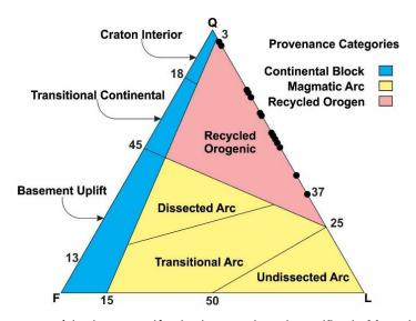
Figura 15 - Diagrama ternário de proveniência dos arenitos da região de Mucuri – Costa Dourada (Modificado de Dickinson et al, 1983 a).
