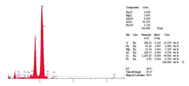
Figura 21 - Espectro do EDS mostrando assinatura química do quartzo, ponto 3 - Fig. 13C. Fonte: Autoria própria.
