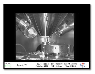
Figura 8 - Interior da câmara de análises do MEV. Fonte: Autoria Própria.
