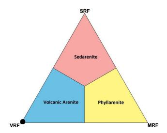
Figura 14 - Diagrama ternário de reclassificação das amostras dos arenitos da região de Mucuri — Costa Dourada (Modificado de Folk, 1980)
