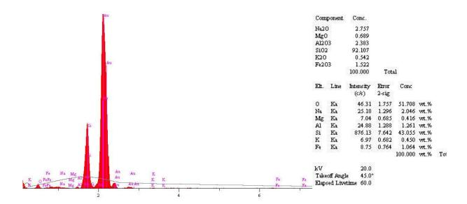
Figura 17 – Espectro do EDS mostrando assinatura química do quartzo, ponto 1 - Fig. 13B. Fonte: Autoria própria.
