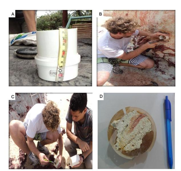
Figura 7 - A) Tubo PVC cortado e pronto para coleta das amostras. B) Coleta das amostras no campo. C) Aplicação da resina para consolidação dos sedimentos. D) Amostra em laboratório petrográfico após a aplicação da resina. Fonte: Autoria própria.
