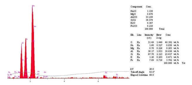
Figura 19 - Espectro EDS mostrando assinatura química da caulinita, ponto 2 - Fig. 13B. Fonte: Autoria própria.
