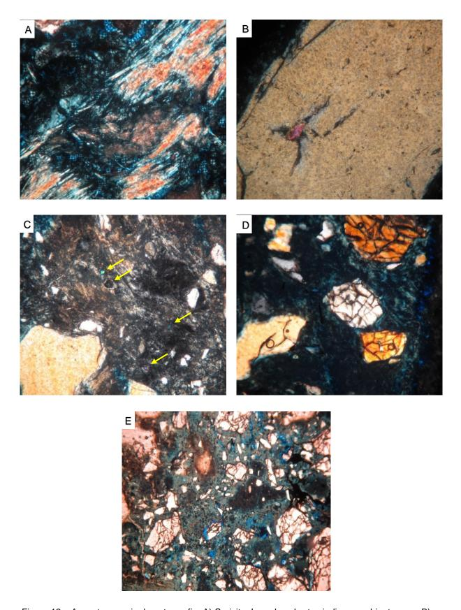
Figura 12 – Aspectos gerais da petrografia. A) Sericita. Lamelas abertas indicam ambiente raso. B) Zircão associado a grão de quartzo. C) Zircão detrítico e a influência da sua radioatividade. D) Ortopiroxênio. E) Quartzo fragmentado indicando provável evento explosivo. Fonte: Autoria Própria.
