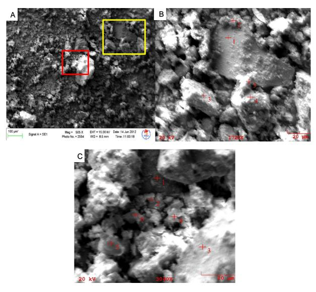
Figura 16 – A) Imagem de MEV com as características sedimentológicas do arenito de Costa Dourada. B) Aproximação de 1720x da região destacada em amarelo para análise EDS. C) Aproximação de 3040x da região destacada em vermelho para análise EDS. Fonte: Autoria própria.
