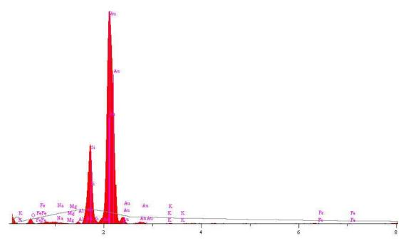
Figura 9 - Espectro EDS do quartzo. Os diferentes picos para um mesmo elemento (Fe) representa energias variadas dos fótons. O pico de ouro (Au) é devido a fina camada de metal aplicada na amostra. Fonte: Autoria própria.
